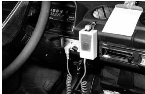
Lada taxi gépkocsi műszerfalára szerelt URH adó-vevő berendezés
