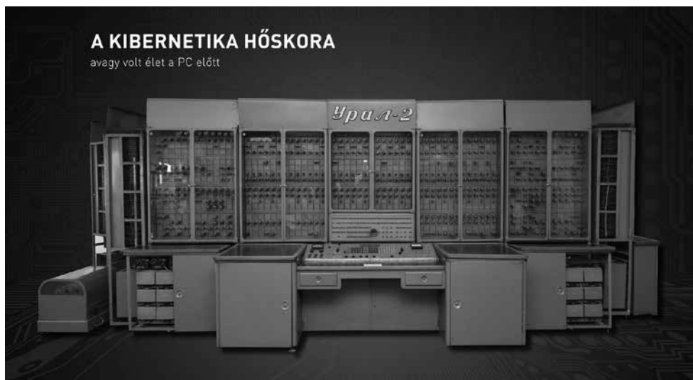
14. kép - Egy teremnyi számítógép nem jelenhetett meg eredetiben. URAL-2 számítógépet ábrázoló kép (fotó: Atomenergetikai Múzeum)
