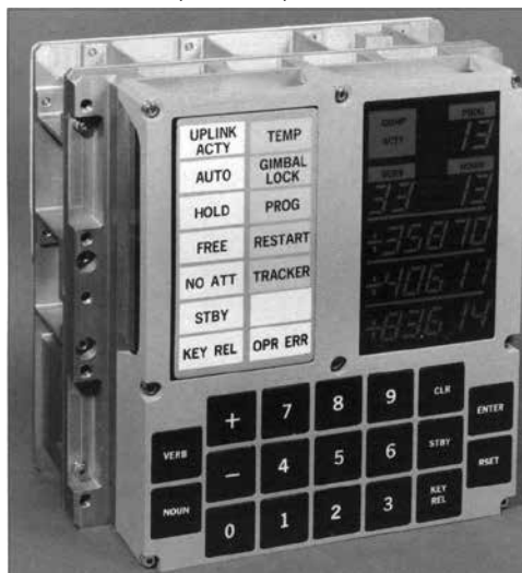
5. ábra. Komplet DSKY modul
