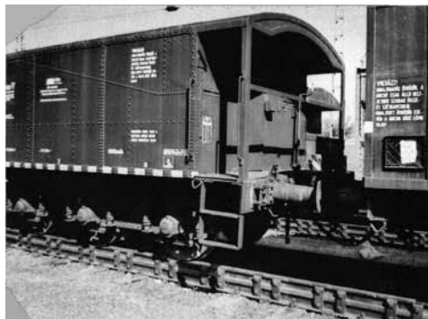
Négytengelyes hídmérlegvizsgáló kocsi
