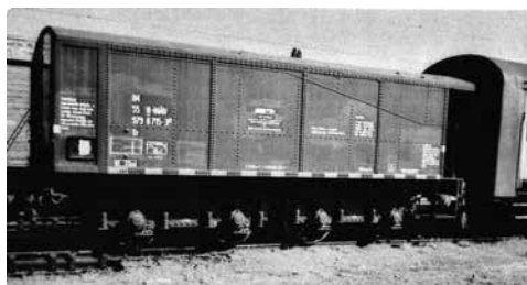
Négytengelyes hídmérlegvizsgáló kocsi
